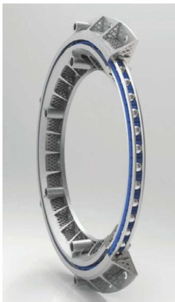
Questo speciale cuscinetto realizzato da Franke con la sinterizzazione laser di polveri di alluminio in 3D, ha un diametro di 300 mm e un peso di soli 800 grammi, ovvero di 14 inferiore a un analogo cuscinetto in acciaio.
